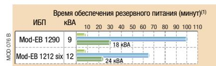
■ Стандарт      (1) Максимальное время обеспечения резервного питания (ВУТ) при 75% нагрузки
