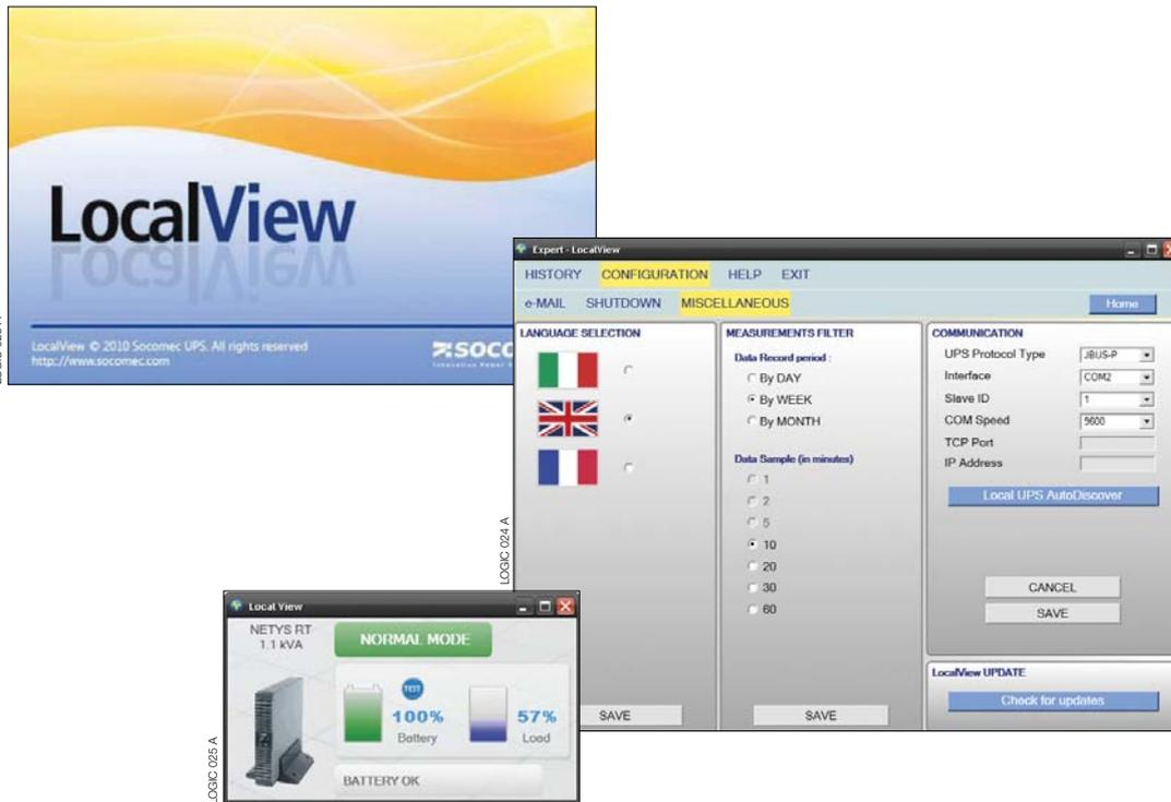
LOCAL VIEW — это программное обеспечение для мониторинга и управления системами ИБП через порт USB или последовательный порт RS232, позволяющее провести автоматическое отключение системы в случае продолжительного перебоя в подаче электроэнергии.
