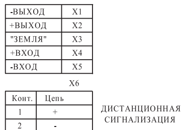
Рисунок 14.2 - Схема подключения стабилизатора СПН-3 (для самостоятельной поставки)
