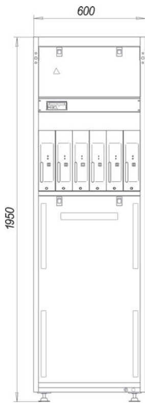
Рисунок 4.12 - Габаритный чертеж УЭПС-3 60/150-0606-М, УЭПС-3 48/180-0606- М, УЭПС-3 24/300-0606-М
