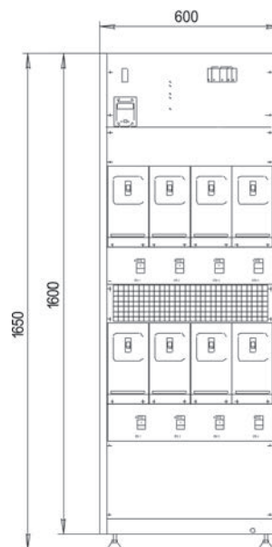
Рисунок 13.3 - Габаритный чертеж ССПН-4
