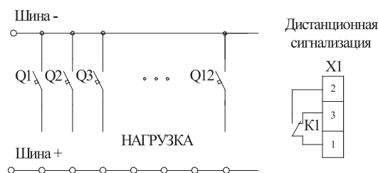
Рисунок 24.1 - Схема подключения щитов ЩРЗ 24-4, ЩРЗ 48-4, ЩРЗ 60-4
