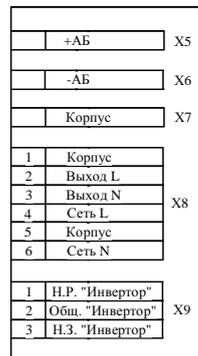
Рисунок 17.2 - Схема подключения ИЦ-600БП-19
